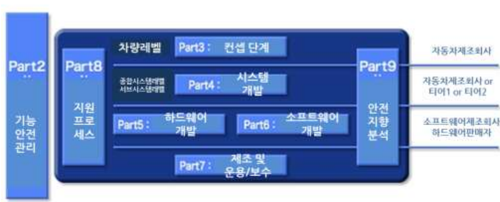
그림2. 자동차 개발 프로세스에 있어서의 ISO26262의 담당 범위와 규격 문서 각 Part의 관계
